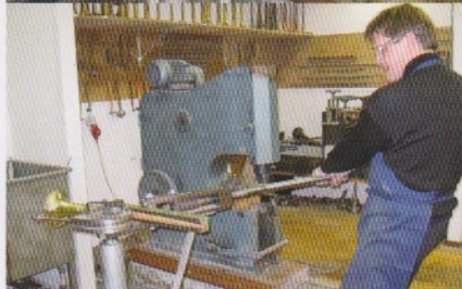
ベルを曲げるための工具と作業風景。
