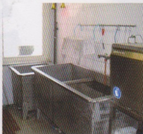
超音波洗浄を行うための浴槽。
