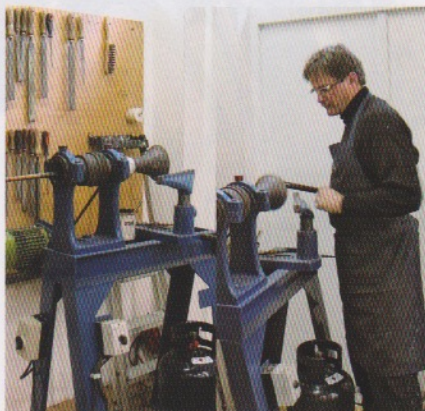
ベルを形成するための工具と作業風景。
