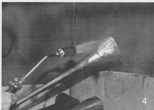
Foto 3,4,5. Door regelmatig bekloppen en verhitten wordt de beker gericht.
