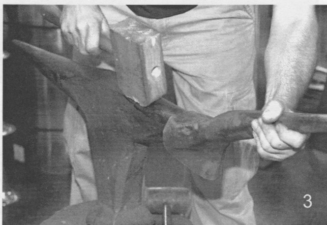
Foto 3,4,5. Door regelmatig bekloppen en verhitten wordt de beker gericht.
